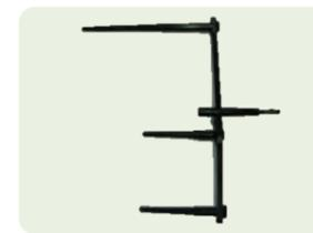
一部の樹脂製品では成形時に発生する樹脂ランナーを破碎し、工程内で再利用
