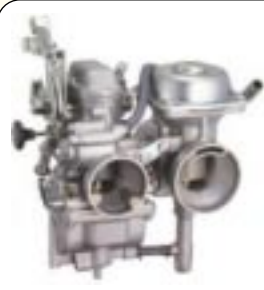
省資源排ガス対策の先進的な モーターサイクル用気化器
