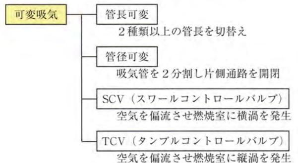
図4 可変吸気の種類
