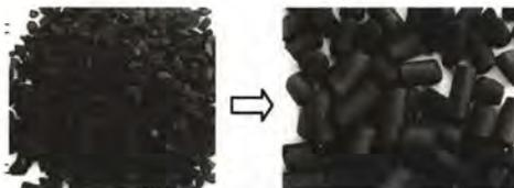
図6 破碎炭から造粒炭へ移行
