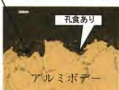
図8 アルミボデーの腐食例
