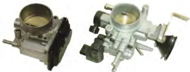
図5 電子スロットルボデー(左)とメカニカルスロットルボデー(右)
