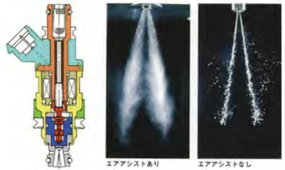
図8 エアアシストインジェクタの構造と噴霧
