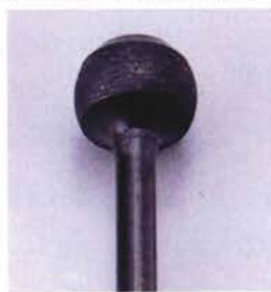
図3: 冷間鍛造成形のオニオン
