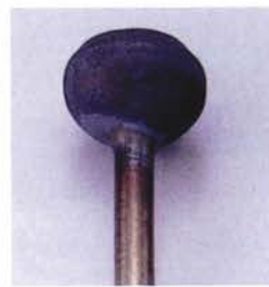
図4: 電気アプセッタ成形のオニオン
