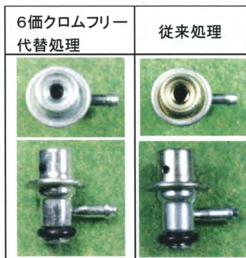
図10 プレッシャレギュレタの耐燃料性試験500時間後の外観写真
