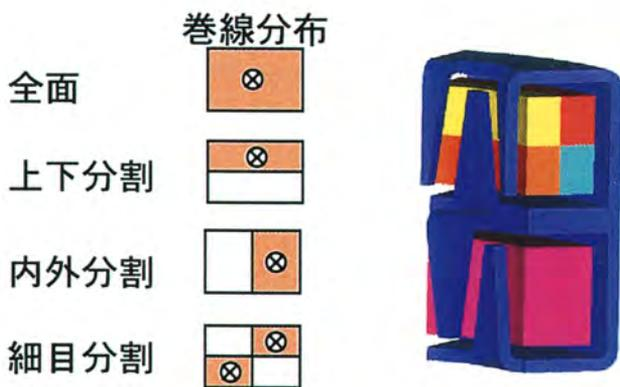
図5 バイファイラ巻線分布のモデル化
