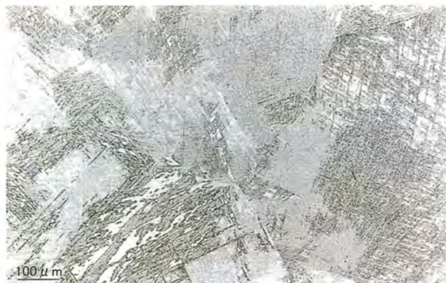
図3 インテークバルブ軸部断面組織
