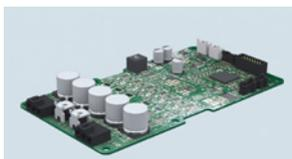
モータを制御するために必要な回路基板
