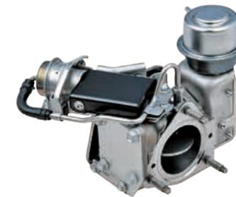
ディーゼルエンジンのDPF<sup>\*3</sup>に堆積したPM<sup>\*4</sup>を燃焼させ、DPFを浄化することが必要です。この排気圧力制御バルブにより排気ガスを高温にすることが可能となり走行中にPMを連続的に燃焼することができます。
