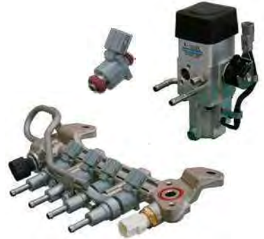
CNG用デリバリアセンブリ & 高圧レギュレータ
