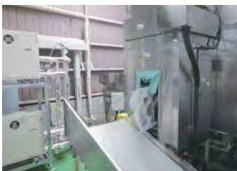
循環加熱ヒートポンプ式通箱洗浄機
