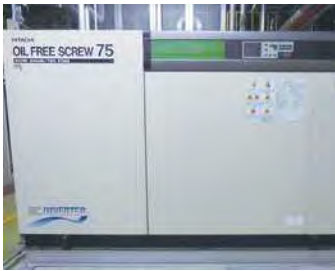
75KWインバーター制御式圧縮機
