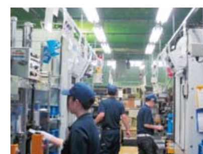
生産工程の照明をLED化して省エネ(愛三熊本:熊本県)
