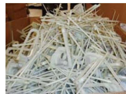
樹脂成形屑を材質ごとに振り分けて再資源化を推進(FPI:アメリカ)
