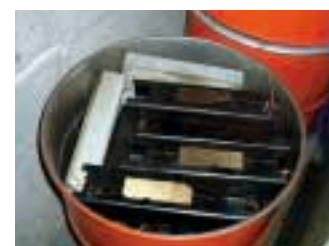
照明用PCB安定器の保管
